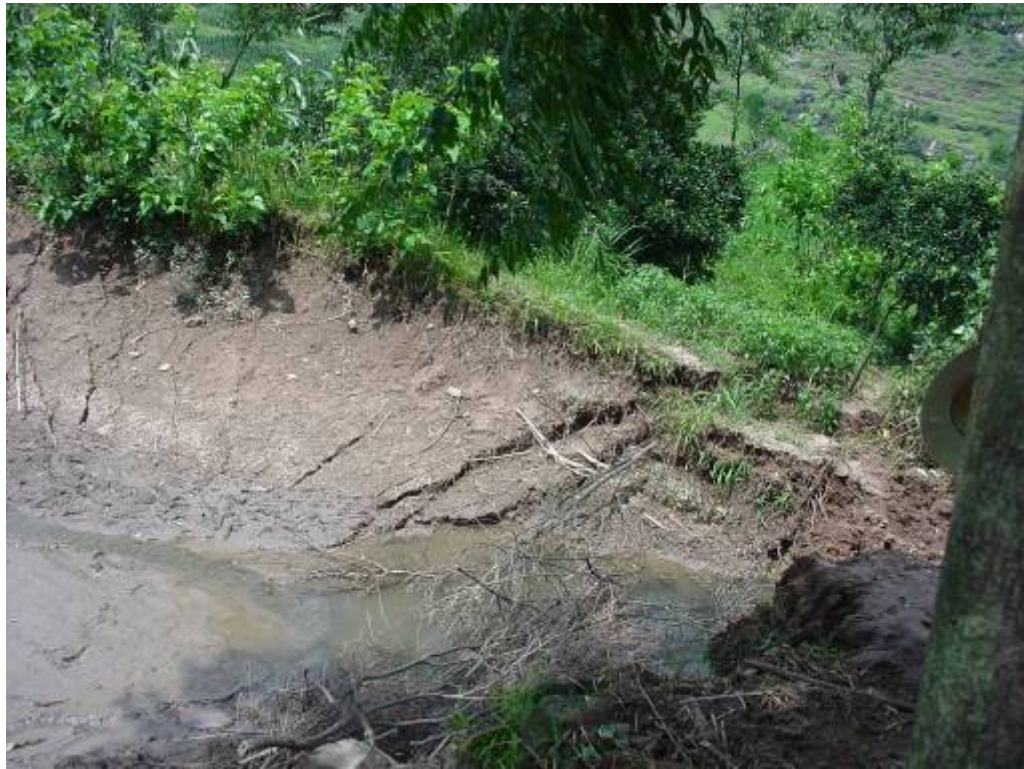
滑坡体上的池塘极易拉裂，导致地表水渗入滑坡内，加剧滑动（重庆云阳，2007）
