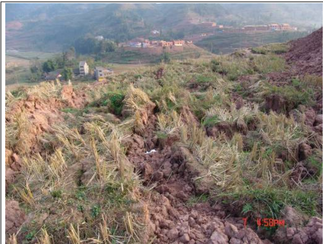
滑坡体上稻田拉裂，地表水渗入滑坡内，加剧滑动（四川宣汉,2004）
